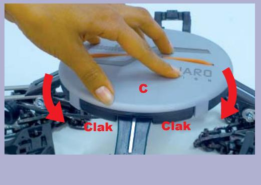
**HR** **Reguliranje prečnika:** otvorite poklopac (C) centralnog dijela, odblokirajte ježićak za dihotovanje (E) i, pritiskom na gumb (F), okrenite regulacioni disk (G) sve dok ne izđe gumb što se događa na polovini kruga u skladu s pozicijama A, B, C i D koje se vide na krakovima. Te pozicije se vide u tabeli priloženoj stupcu P. Zatvorite dobro poklopac.
