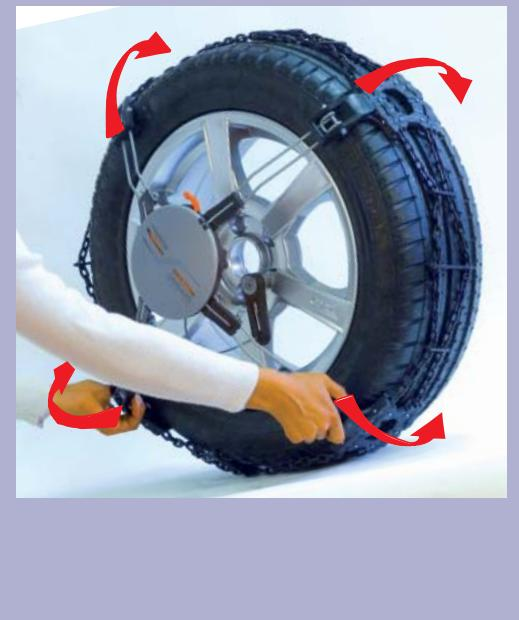
**HR** Podesite lanac i bočno i na donjem dijelu, vodeći posebice računa da, ploče i lanc yanjske strane gume budu postavljeni što je moguće više ka unutrašnjosti kočića i na uniformiran način.
