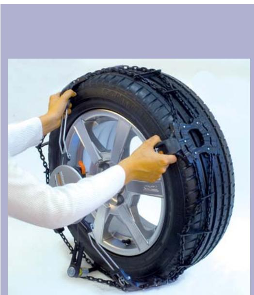
**IT** Appoggiate la catena sul battistrada della ruota partendo dalla parte superiore e mantenendo la posizione dei bracci come nelle figure a lato.
