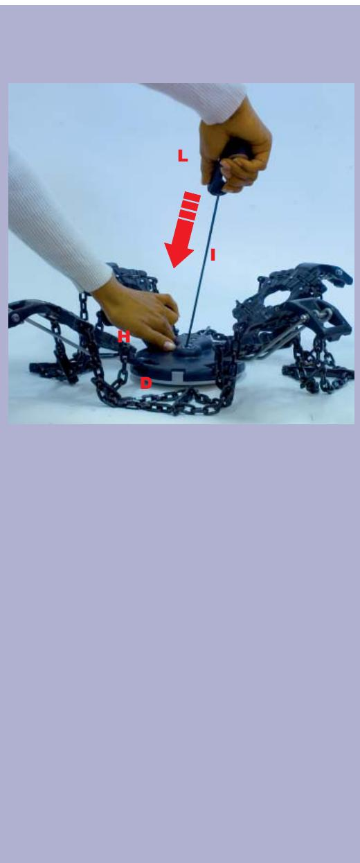
**IT** Impugnate saldamente leva di serraggio (L) e il corpo centrale (D), premete la levetta (H) ed accompagnate il cavo (I) durante l'avvolgimento fino al completo recupero.
