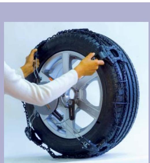
**IT** Sistematicate la catena anche sui lati e sulla parte inferiore, facendo molta attenzione che le piastre chiodate e la catena battistrada siano disposti il più possibile all'interno della ruota e in maniera uniforme.
