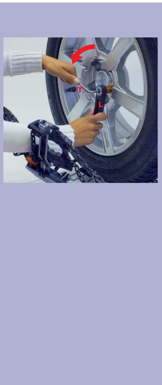
**IT** Per mezzo della chiave (T) in dotazione, allentate la pinza e sfiate il complesso leva di serraggio (L) / pinza e porta pinza (M-N) dal bullone della ruota.
