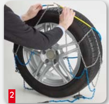
2 Chiudere il cavo all'esterno Engage the cable-hook from the outside
